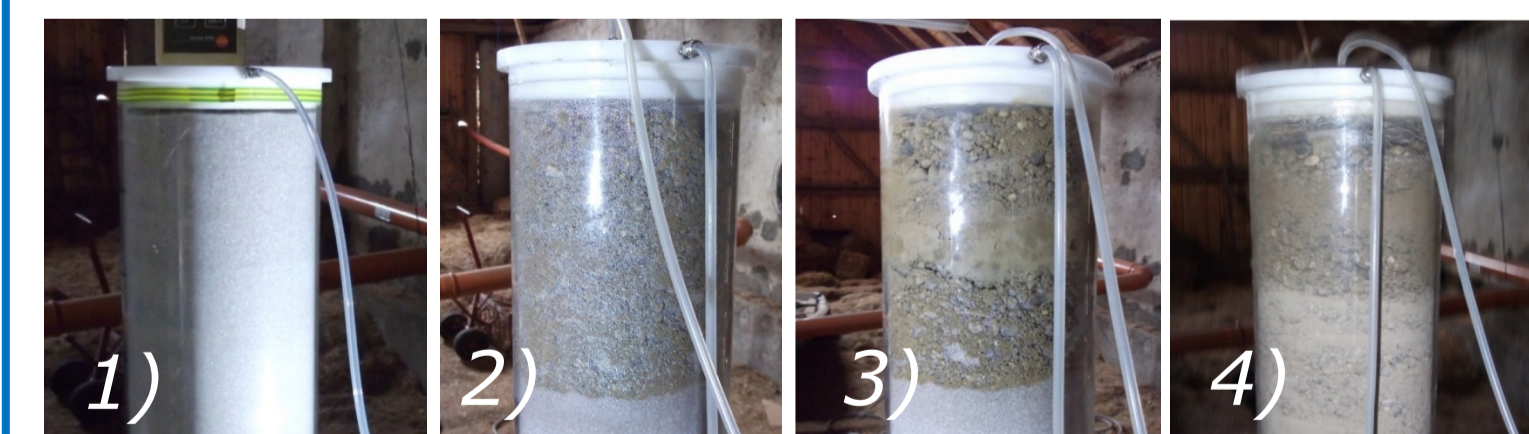
Abb. 4. Verwendete Substrate: 1) Quarzsand, 2) Kies erdfeucht auf Quarzsand, 3) Kies – Ton – Kies auf Quarzsand, 4) Kies erdfeucht, 5) Versuchsaufbau
